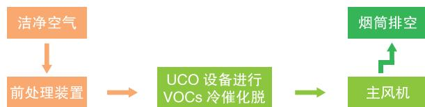
针对非连续工作、中低VOCs浓度的生产企业，贺利氏提出了UCO系统解决方案。在工业设备进行生产时 UCO系统对生产产生的VOCs进行光解和吸附，有效降低VOCs的浓度；在工业生产停止之后，整个UCO系统的会通过持续不断的冷催化脱附技术对吸附系统进行还原再生，保证整个系统的长期有效运行。
