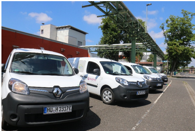
Die H2anau-Flotte umfasst insgesamt sieben Lieferfahrzeuge, die mit Brennstoffzellen ausgestattet wurden.
