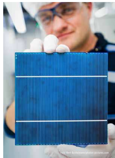
Silberleitbahnen auf Solarzellen werden immer schmaler
