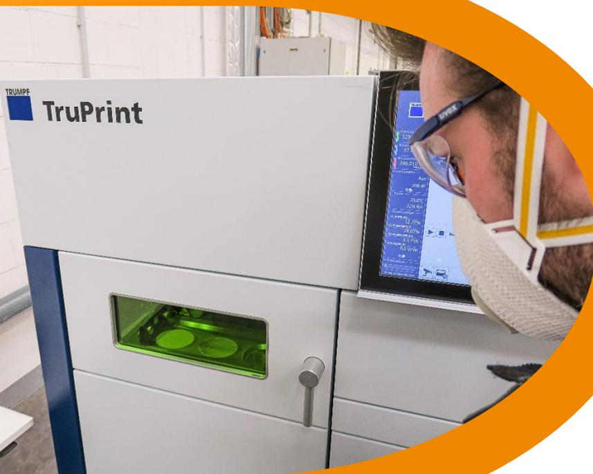
Die amorphen Legierungen benötigen eine sehr schnelle Abkühlgeschwindigkeit, sodass die Schmelze unterkühlt wird und in der amorphen Struktur erstarren kann. Erst mit der amorphen Atomstruktur kann das Material seine Potentiale in den einzigartigen Eigenschaften heben. Die Technologie der Additiven Fertigung kann diese Herausforderung meistern, sodass die TruPrint 1000 die besten Anforderungen dazu mitbringt.
