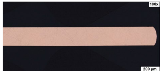
PowerCu-Soft LRB 的截面示意图：自然圆边，无毛刺
