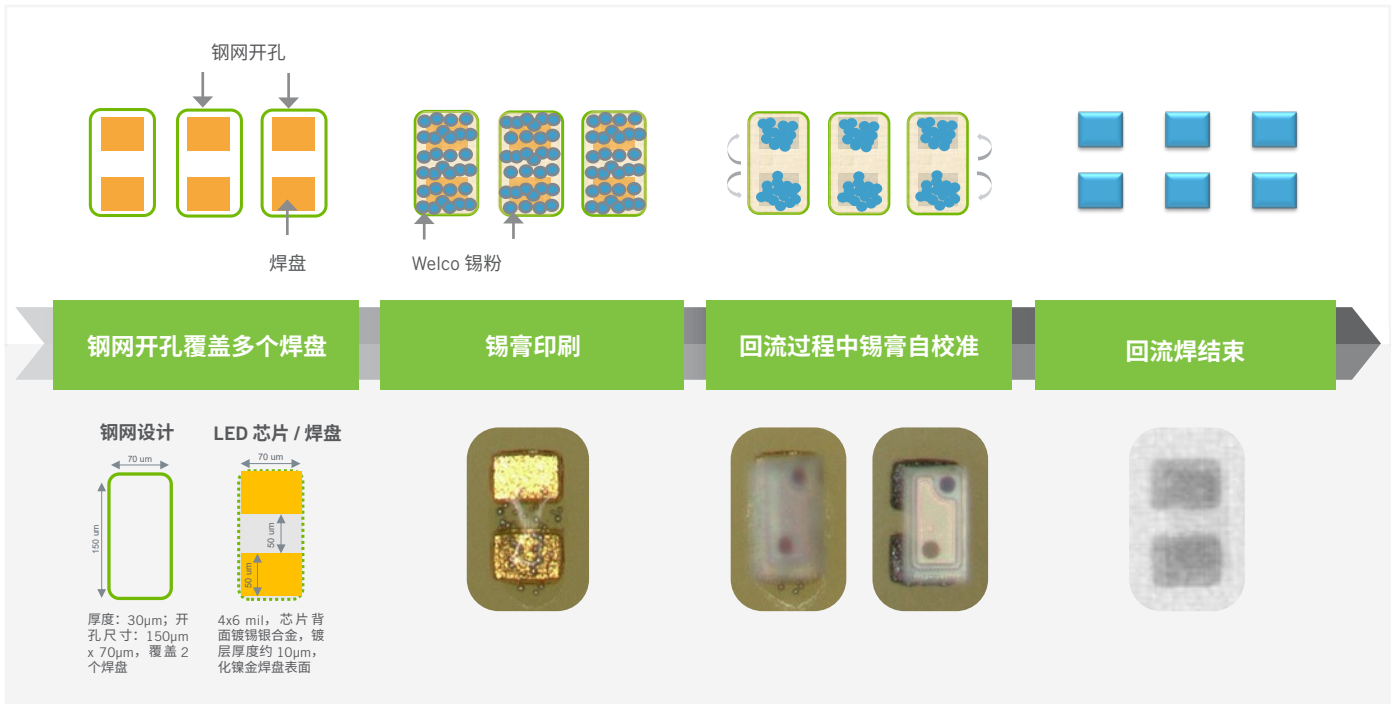
图 1：具有自校准能力的 Welco LED101 印刷锡膏
