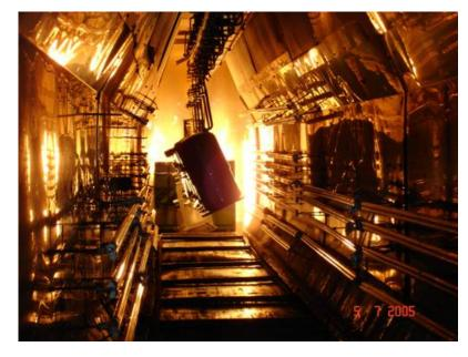
Es hat sich gezeigt, dass die Halte- oder Einbrennzeit für Pulverlack mit Hilfe der Infrarot-Strahlung stark verkürzt oder in manchen Fällen sogar komplett eingespart werden kann.
