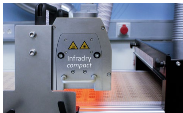
Infrarotstrahlung und Luftmanagement intelligent kombiniert beschleunigen die Trocknung
