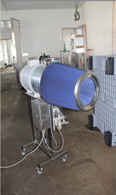
Ozonfreie Strahler mit 254nm UV-Emission, Control Unit mit 200 W Energieverbrauch und passgenauen Klemmfedern.
