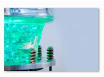
Bild 2: UV- System für die präparative Photochemie (Peschl Ultraviolett GmbH)
