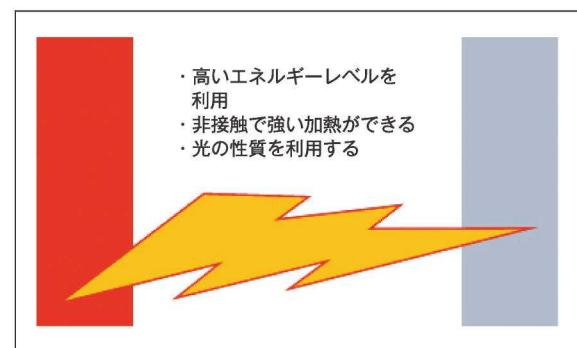
図3 輻射加熱の原理
