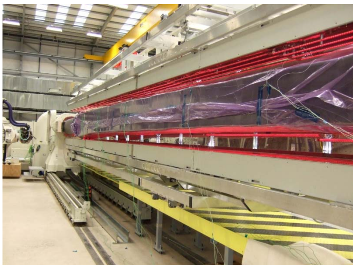
欧州における航空機部品向け赤外線加熱システム例
