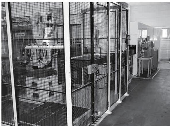
ロボットはパレットからタイルを持ち上げ、塗装硬化用のコンベヤ上に設置するようにプログラムされている
