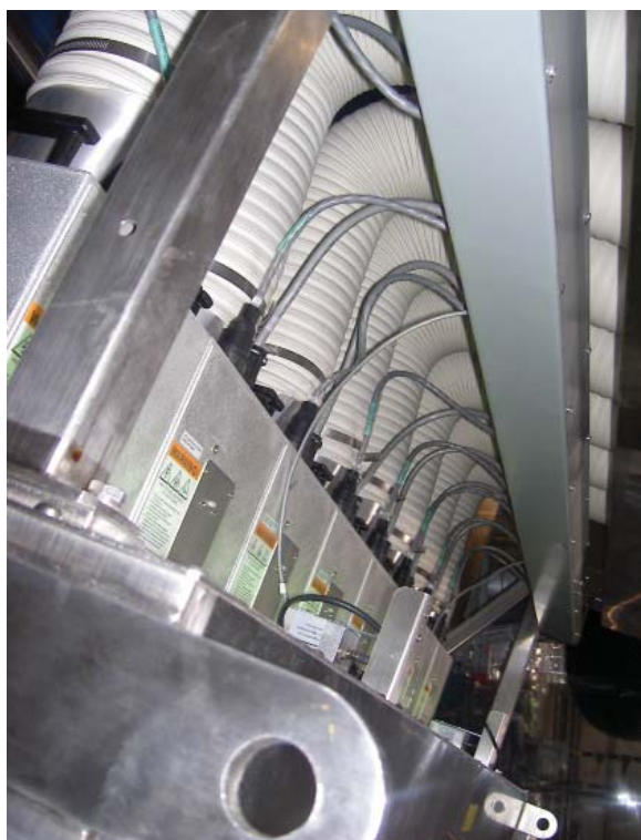
耐傷性ハードコートフィルムの硬化にヘレウスの VPS6/1600 ランプを使用している
