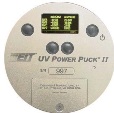
Power Puck II (パワーバック II) A four band radiometer
