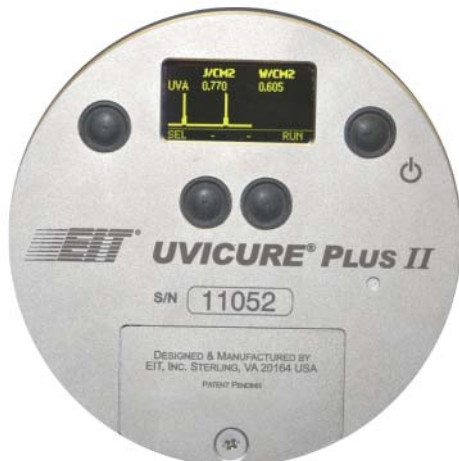
UVICURE Plus II (UVI キュアプラス II) A single band radiometer
