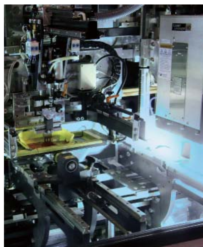
Kammann 社の K13-G スクリーン印刷機 ヘレウスの Light Hammer® 10 UV ランプを搭載
