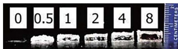
図 2: 時間経過に伴う透明セルの影部内への硬化の進行 (図内の番号は照射後の時間を示す) [CDE, 0.5 mol% IPB, 光照射: 56 mW/cm 2 , 照射時間: 5 分、環境: 大気、温度: 50°C]
