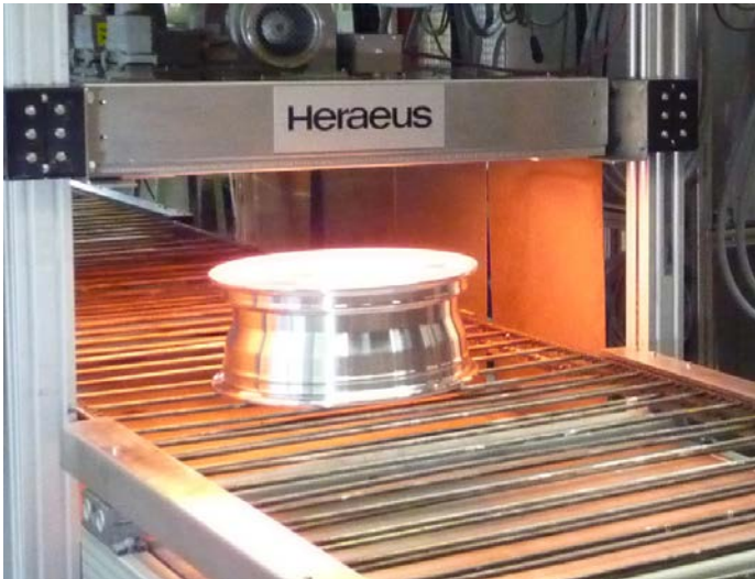
Carbon Infrarot-Strahler beschleunigen die Pulverlackierung von Alufelgen.
