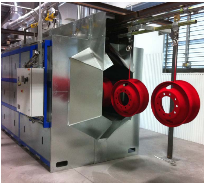
Gaskatalytische Infrarot-Öfen zum Angellieren und Durchhärten von Pulverlack.
