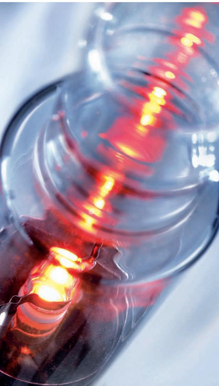
空心阴极灯 (HCL) 是设计用于原子吸收 (AA) 仪器的放电灯。在其玻璃壳内部包含由元素制成的阴极、阳极和惰性填充气。
