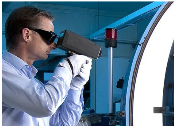
Die Ulbricht-Kugel ermöglicht schnelle und kostengünstige Messungen
