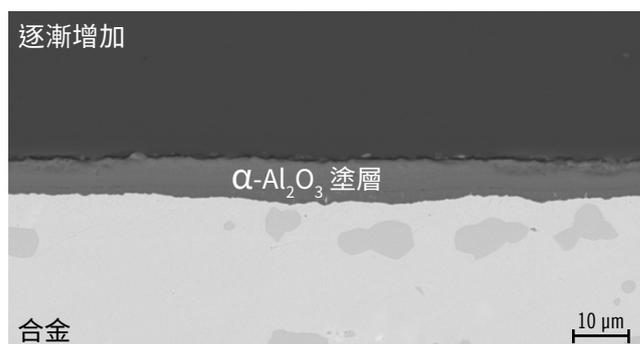
$\alpha\text{-Al}_2\text{O}_3$ 塗層樣品
