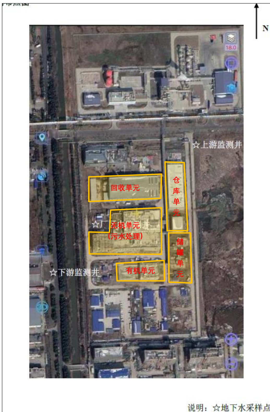
图 2.3-2 厂区地块地下水监测布点图（来源于企业提供的 2020 年监测报告）
