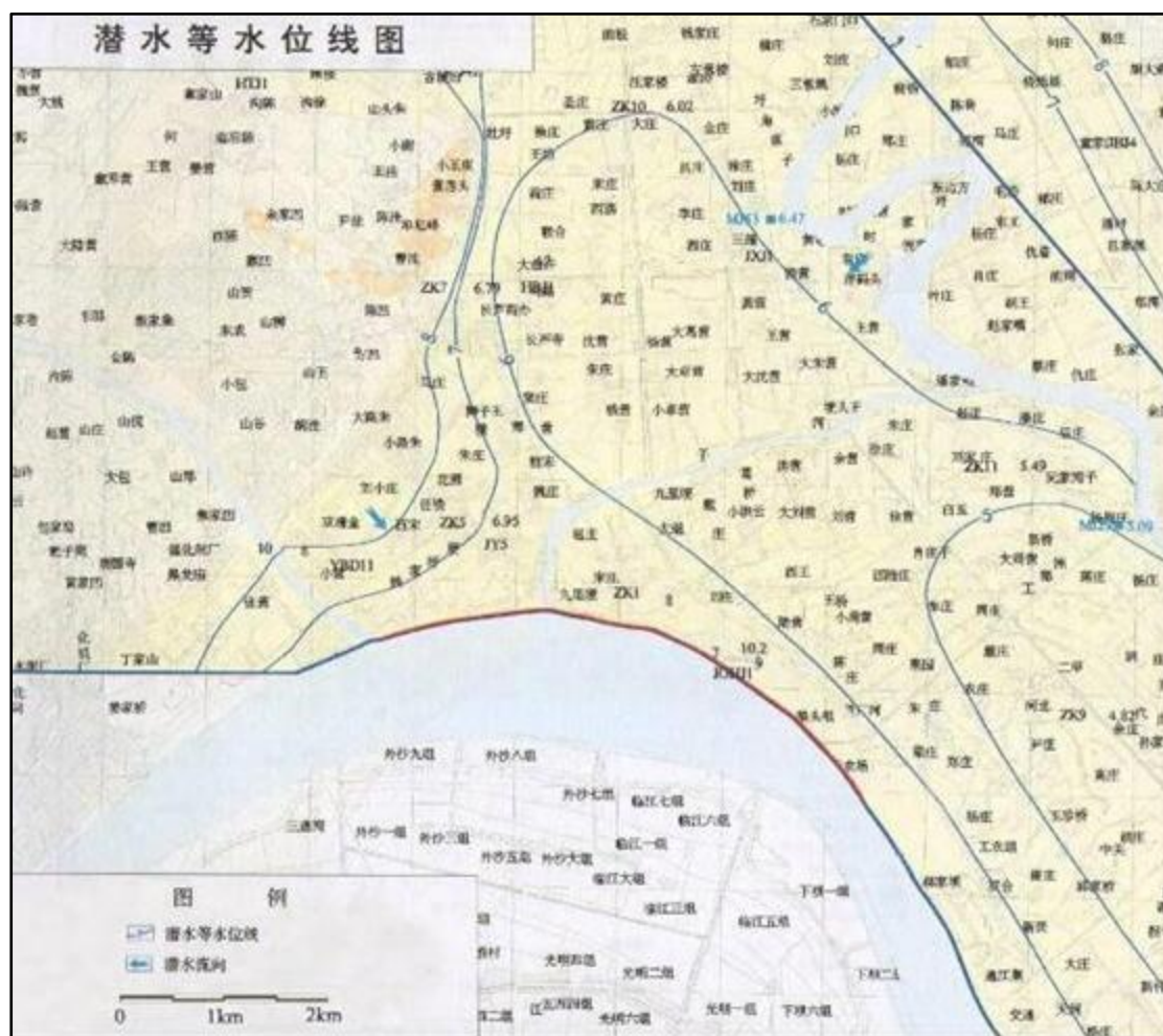
图 2.2-1 区域地下水流向示意图，主要向长江方向迁移
